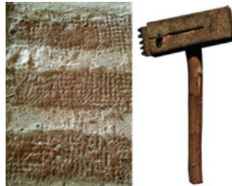
**Abujardar.** Labrar la piedra mediante bujarda, martillo de dos bocas de sección cuadrada provistas de dientes en forma de punta de diamante repartidas de manera uniforme cuya función es la de igualar planos de cierta amplitud.
